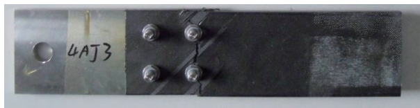
图 8 螺栓连接试验破坏模式
