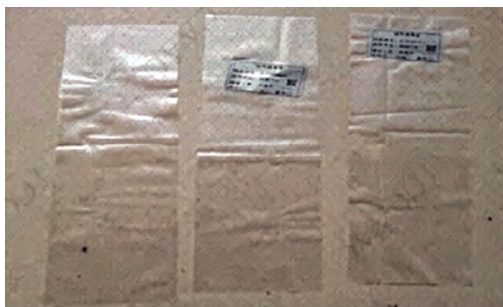
(a) 面罩杯模拟切块燃烧前后形态对比
