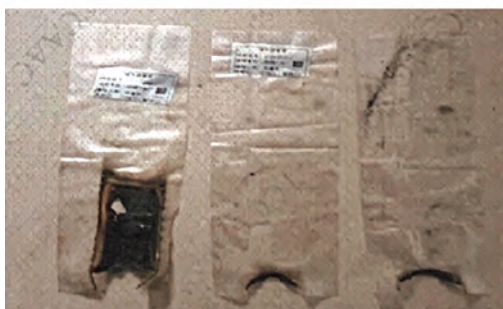
(b) 储气袋模拟切块燃烧前后形态对比
