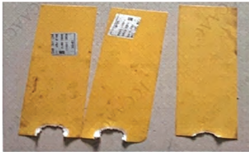
(a) 面罩杯模拟切块燃烧前后形态对比
