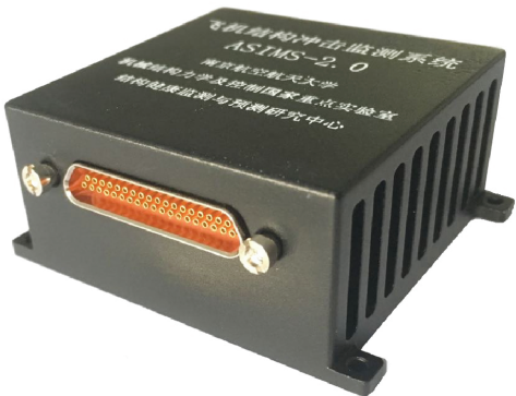
图 3 低功耗小型化冲击监测系统
