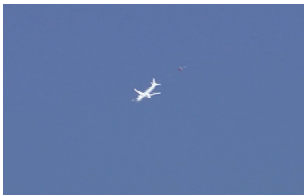
图 10 飞机 A 模型大气自由飞反尾旋伞改出试验
