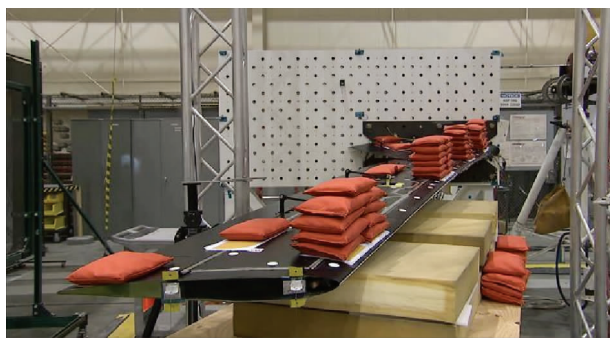
b) 模型(机翼)静力试验
