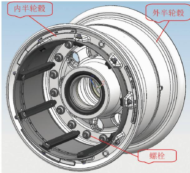
图2 轮毂结构示意图
