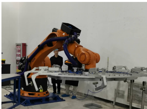
图 19 自动化翻转与定位工装
