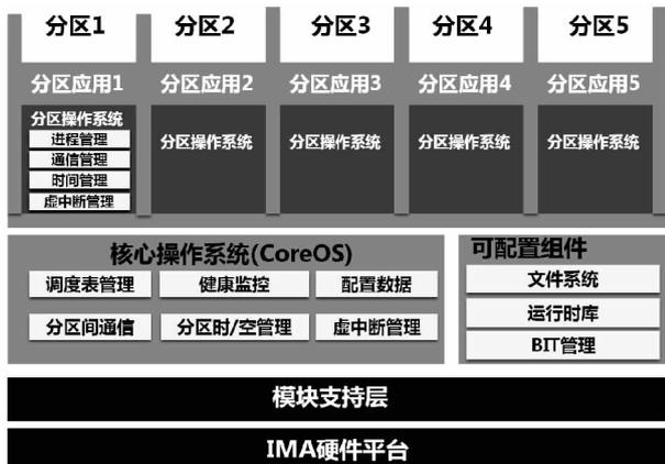
图 1 IMA 系统结构图
