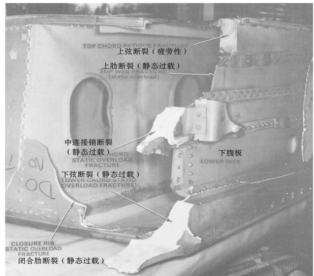
图3 B-BEBP上失效的连接销
