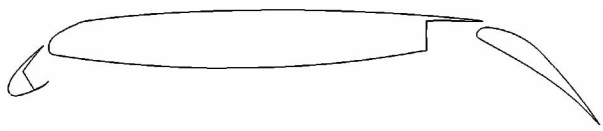
图3 带有缝翼凹腔挡板的三段翼型模型 [7]
