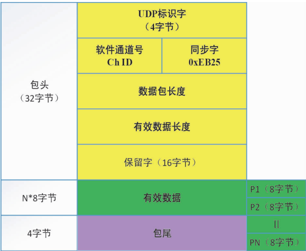
图 9 试飞参数封装数据格式
