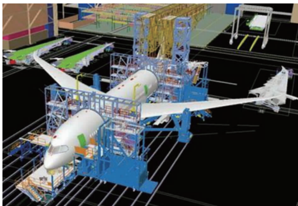
图 5 波音 787 数字样机模拟全机总装
