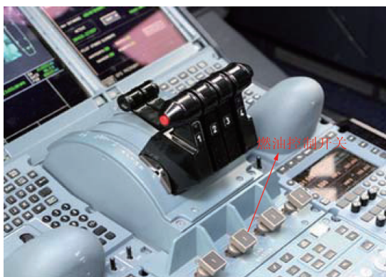
图 7 A380 燃油控制开关结构图
