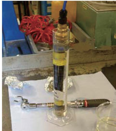
图 12 排水管耐腐蚀试验示意图
