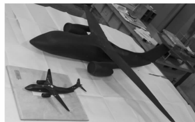
c) T-105立式风洞尾旋试验模型与解码模型对比
