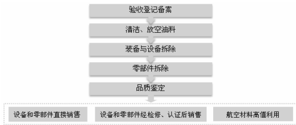
图 2 飞机拆解流程
