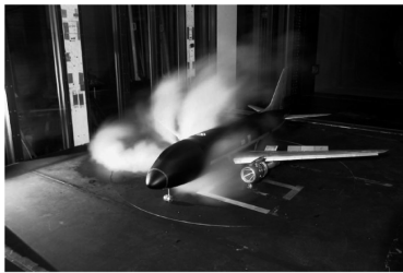
图 6 全机反推力风洞试验
