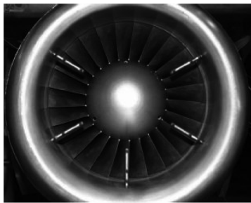
图 7 安装总温传感器的带动力发房
