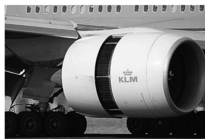
图1 格栅式反推力系统
