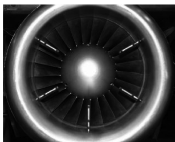
图7 安装总温传感器的带动力发房
