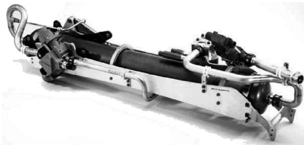
图 7 A320 飞机惰化系统测试构型图
