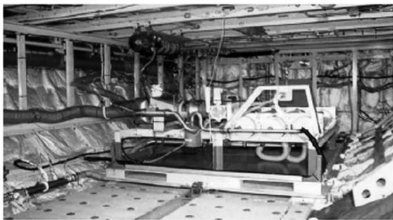
图 6 波音 737 飞机惰化系统测试构型图
