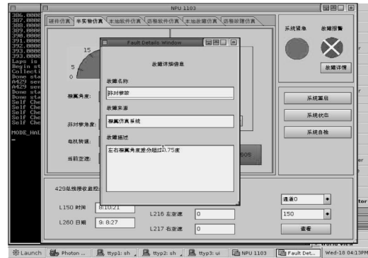
图6 模拟真实襟翼故障注入显示结果
