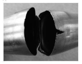
图 1 异管破裂图
