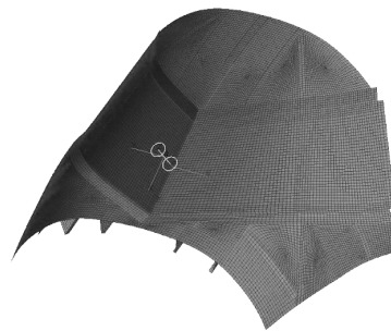
图 23 鸟体垂直撞击主骨架模型
