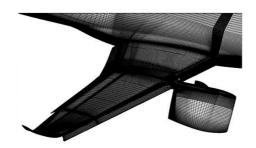
图 11 着陆构型三维结构网格
