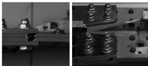
图 25 1 型试验件失效位置示意图
