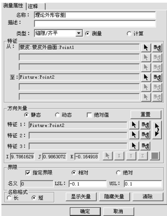
图 1 缝隙/齐平的外形容差测量方法
