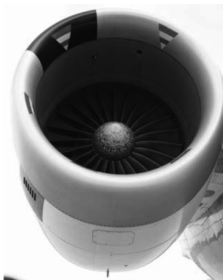
图 8 试验后发动机整流锥局部结冰示意图
