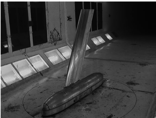
图 10 NF-3 风洞中 SCCH 实验 (布置涡流发生器)
