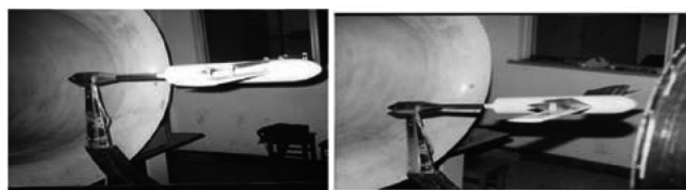
图 17 风洞中的 ZHU's 襟翼
