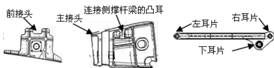
图 1 主起落架连接区各连接结构示意图
