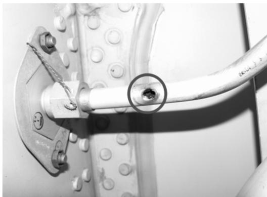
图 1 波音 727 破损的电缆
