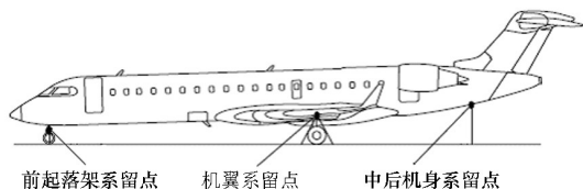
图 1 飞机系留方案示意图
